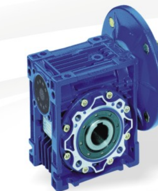
NMRV ® 蜗轮减速机 型号: 025, 030, 040, 050, 130, 150 M_2\text{max}(1400\text{rpm}): 1.550\text{Nm} 减速比: 5 \div 100 功率: 最大至 15\text{kW}
