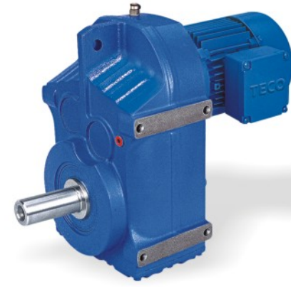
BF系列平行轴-斜齿轮减速机 标配电机能效等级: GB3/IE2 产品型号: ERSF/ERUF 功率: 0.12~200kW 速比: 3.77~31434 输出扭矩: 200~18000N.m
